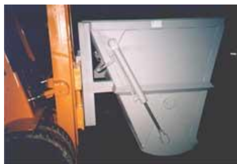
betonszállító üst hydr. Bukatóval
